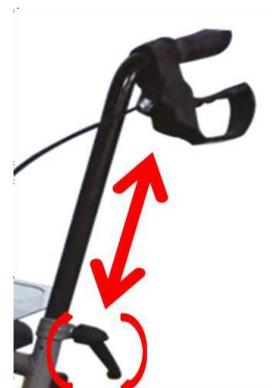
A posição do próprio botão de ajuste pode ser ajustada puxando-o e girando-o simultaneamente. Para alterar a configuração de altura das alças de pressão, gire o botão de ajuste no sentido anti-horário para liberar a fixação. Em seguida, bloqueie a alça na altura desejada, conforme descrito acima.
