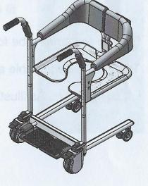
d) Ajuste a altura rodando a manivela para alinhar os locais dos orifícios com os dos eixos rotatórios e, em seguida, conecte nas traves de travagem, a operação é ilustrada ao lado:
