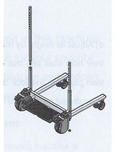
b) Coloque a parte da pega no eixo direito conforme ilustrado ao lado:
