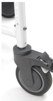
A altura da cadeira e do assento pode ser alterada ajustando a altura do eixo. Para ajustar a altura da rodízio, remova o clipe 'E' ou a porca e o parafuso (setado). Reposicione a haste da rodízio na posição pretendida e volte a colocar o clipe ou a porca e o parafuso «E». Repita os 3 rodízios garantindo que todos estejam colocados na mesma altura.
