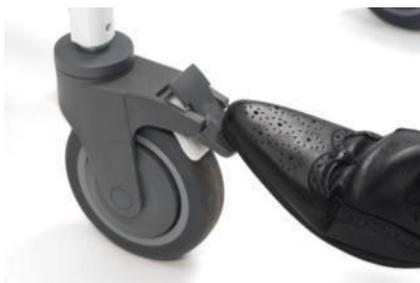
1. Os rodízios podem ser bloqueados de modo que a roda não se possa mover para frente ou para trás. Para bloquear o rodízio, pressione para baixo na aba de bloqueio com um pé (como mostrado).
