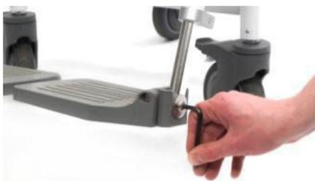
2. Para ajustar o ângulo da placa de pé, afrouxe o parafuso perto da parte inferior do tubo interno (cromado). Ajuste a placa de apoio ao ângulo necessário e volte a fixar o parafuso.
